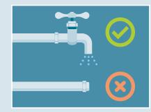
Cuando modifique la instalación no dejar tuberías que no tengan salida de agua o esté estancada.
